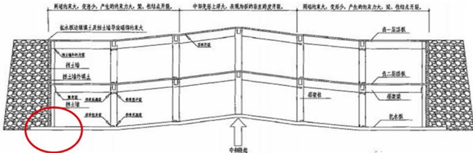
地下车库隆起变形、构件开裂示意图
