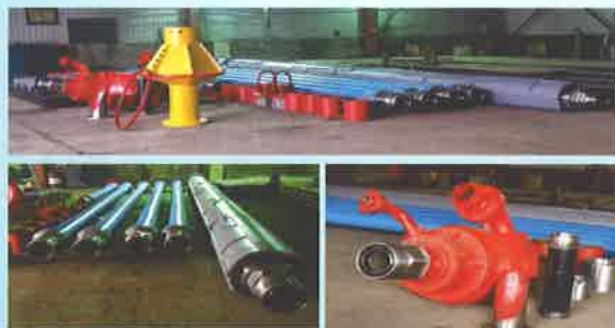
旋挖钻机气动潜孔锤反循环钻进配套实物
