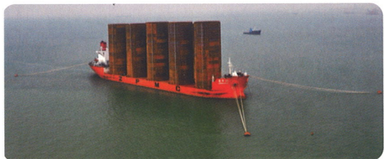
钢圆筒吊装运输示意图
