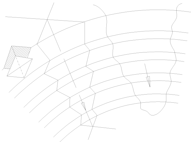
图4-13 双结构面组合块体工程地质模型 及其变形破坏形式
